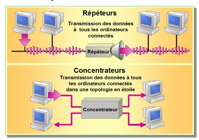
Les répéteurs et les concentrateurs permettent d'étendre un réseau en lui ajoutant plusieurs segments de câble. Il s'agit de périphériques courants, peu coûteux et faciles à installer.
