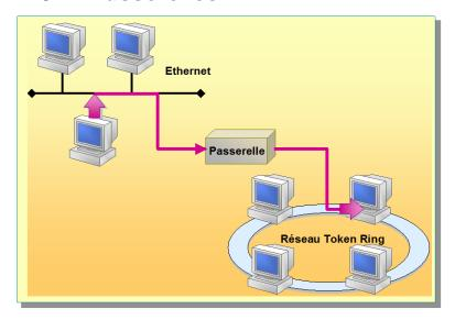
Les passerelles permettent à des architectures réseau différentes de communiquer entre elles. Une passerelle peut réassembler différemment les données reçues d'un réseau pour permettre à chaque réseau de comprendre les données reçues d'un réseau ayant une architecture différente.
