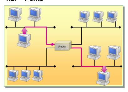
Un pont est un périphérique par lequel transitent des paquets de données entre plusieurs segments de réseau utilisant le même protocole de communication. Un pont transmet un signal à la fois. Si un paquet est destiné à un ordinateur situé sur le segment de réseau de l'expéditeur, le pont conserve le paquet au sein de ce segment. Si le paquet est destiné à un autre segment, le pont transmet le paquet à ce segment.
