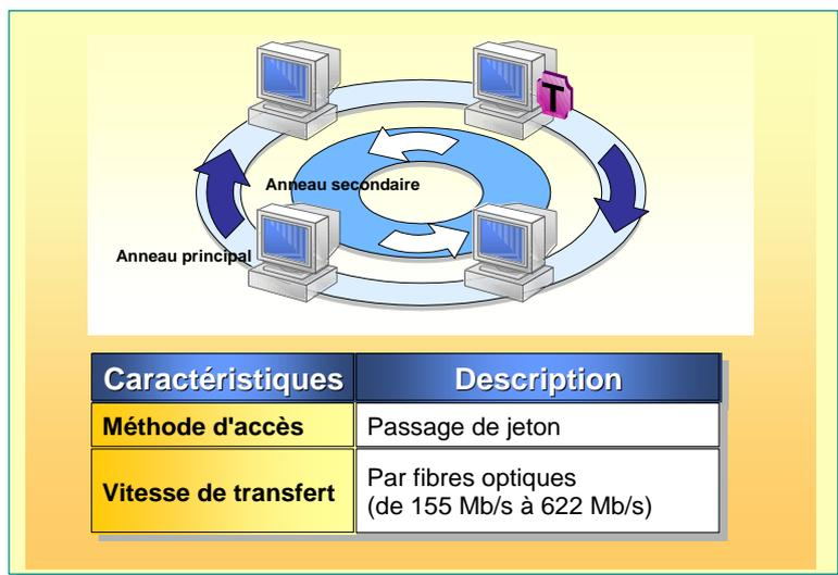
Un réseau FDDI (*Fiber Distributed Data Interface*) permet d'établir des connexions rapides pour différents types de réseaux. Il peut être utilisé avec des ordinateurs qui nécessitent des vitesses supérieures aux 10 Mb/s offerts par le réseau Ethernet, ou aux 4 Mb/s autorisés par les architectures Token Ring. Un réseau FDDI peut prendre en charge plusieurs réseaux locaux de faible capacité nécessitant une dorsale rapide.
