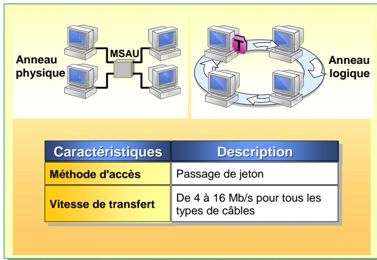
Les réseaux Token Ring sont implémentés dans une topologie en anneau. La topologie physique d'un réseau Token Ring est la topologie en étoile, dans laquelle tous les ordinateurs du réseau sont physiquement connectés à un concentrateur. L'anneau physique est connecté au moyen d'un concentrateur appelé MSAU (*Multistation Access Unit*). La topologie logique représente le chemin, de forme annulaire, parcouru par le jeton entre les ordinateurs.
