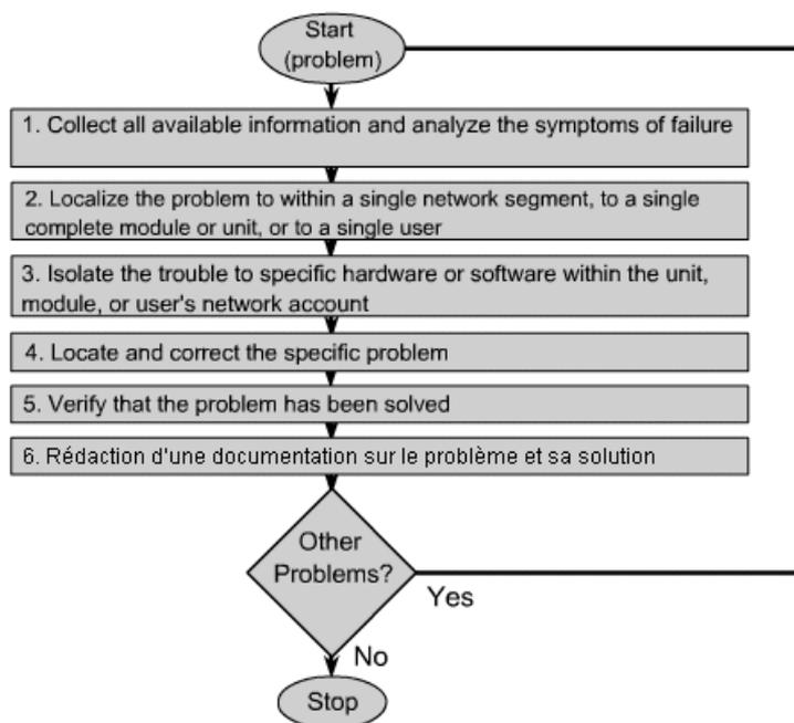
La figure illustre une autre approche du dépannage. Le dépannage ne se limite pas à ces deux méthodes. Toutefois, le recours à un processus structuré est d'une importance capitale pour le fonctionnement efficace et sans coupure d'un réseau.
