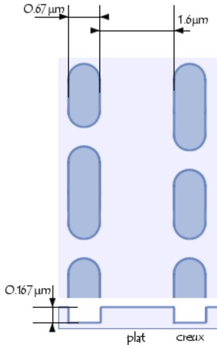
Le laser utilisé pour lire les CD a une longueur d'onde de  $780\ \text{nm}$  dans l'air. Or l'indice de réfraction du polycarbonate étant égal à  $1.55$ , la longueur d'onde du laser dans le polycarbonate vaut  $780 / 1.55 = 503\ \text{nm} = 0.5\ \mu\text{m}$ .
