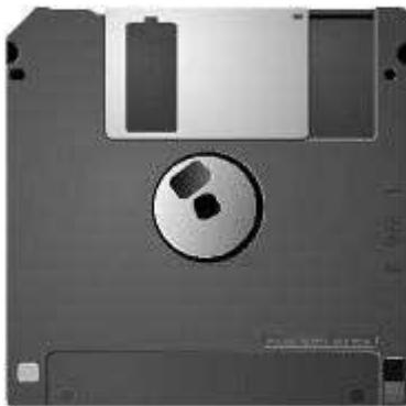
Une disquette est composée d'un disque que l'on pourrait comparer à un plateau du disque dur.
