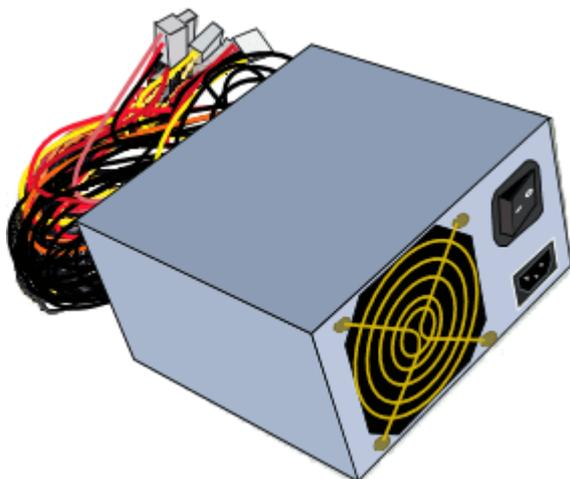
Il est essentiel de s'assurer que le commutateur est bien positionné sur le bon voltage afin de ne pas risquer de détériorer des éléments de l'unité centrale.
