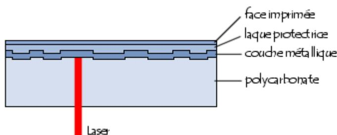
La couche réfléchissante possède de petites alvéoles. Ainsi lorsque le laser traverse le substrat de polycarbonate, la lumière est réfléchiée sur la couche réfléchissante, sauf lorsque le laser passe sur une alvéole, c'est ce qui permet de coder l'information.
