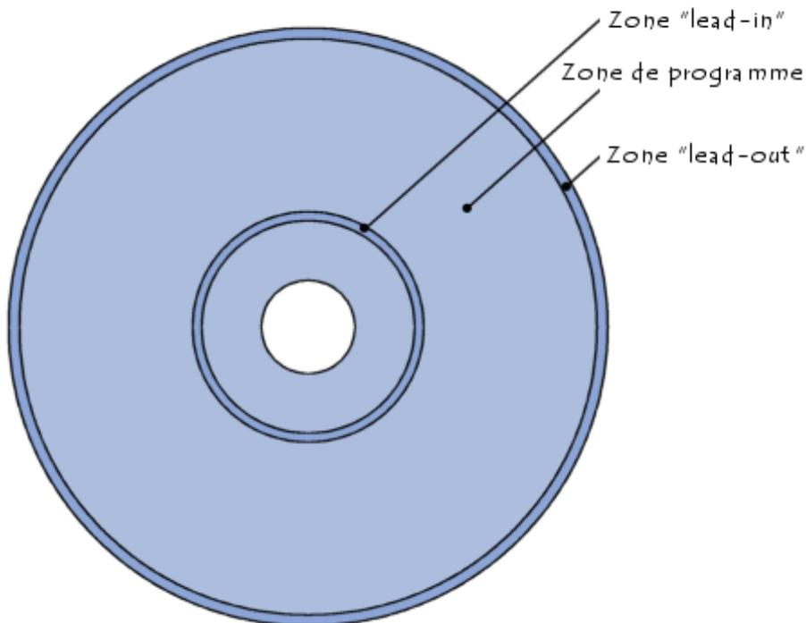
Un CD-R contient, en plus des trois zones décrites ci-dessus, une zone appelée *PCA (Power Calibration Area)* et une zone *PMA (Program Memory Area)* constituant à elles deux une zone appelé *SUA (System User Area)*.
