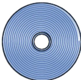
Les CD achetés dans le commerce sont pressés, c'est-à-dire que les alvéoles sont réalisées grâce à du plastique injecté dans un moule contenant le motif inverse.
