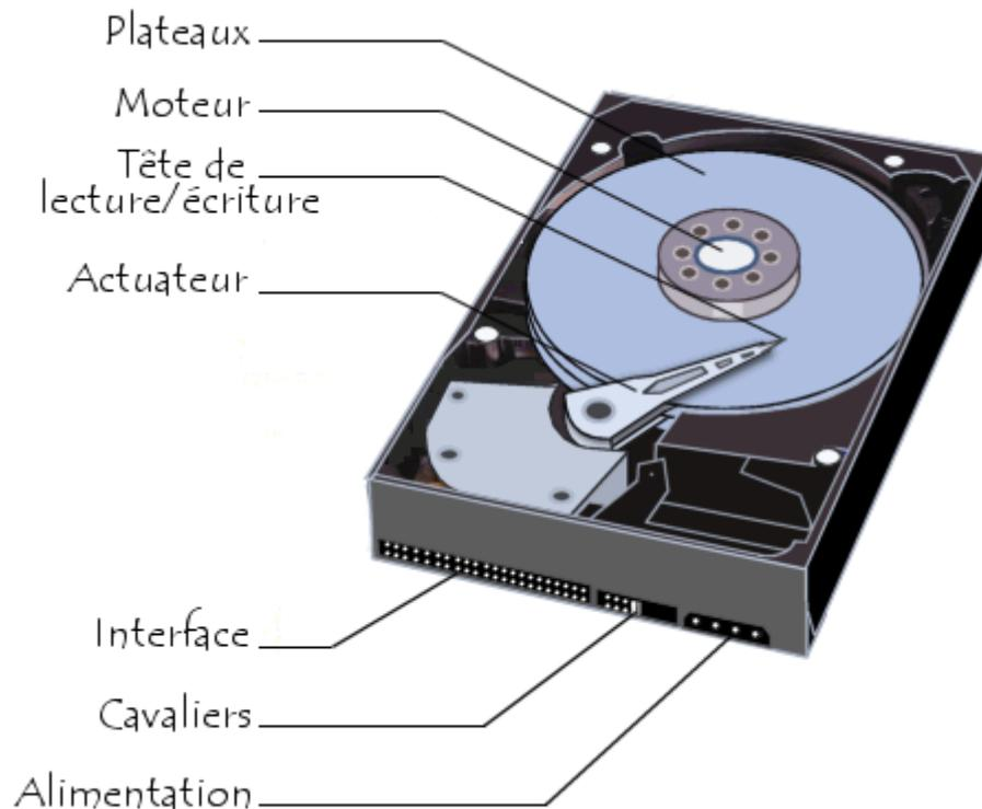
Les disques tournent très rapidement autour d'un axe (à plusieurs milliers de tours par minute actuellement) dans le sens inverse des aiguilles d'une montre. Un ordinateur fonctionne de manière binnaire, c'est-à-dire que les données sont stockées sous forme de 0 et de 1 (appelés bits). Il existe sur les disques durs des millions de ces bits, stockés très proches les uns des autres sur une fine couche magnétique de quelques microns d'épaisseur, elle-même recouverte d'un film protecteur.
