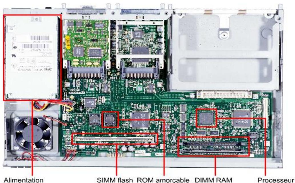
Les composants proprement dits et leur emplacement varient selon les modèles. La figure identifie les composants internes d'un routeur 2600.
