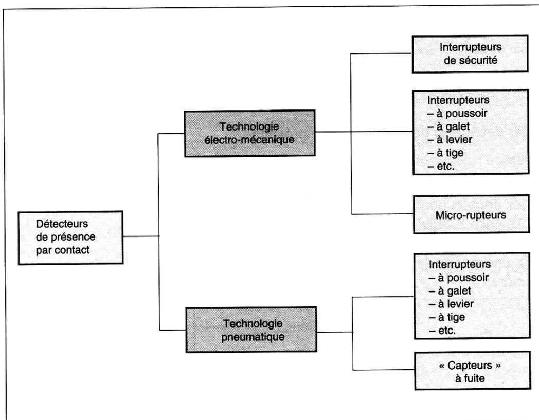
Figure 11 - Typologie des détecteurs de présence par contact
