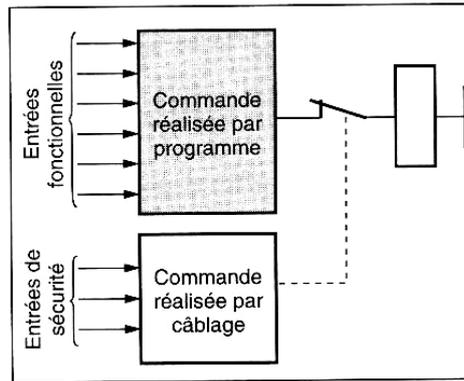
Figure 28 – Commande mixte d'une chaîne fonctionnelle
