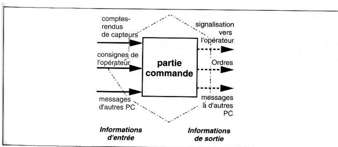
Figure 1 - Catégories d'informations d'entrées utiles à la commande
