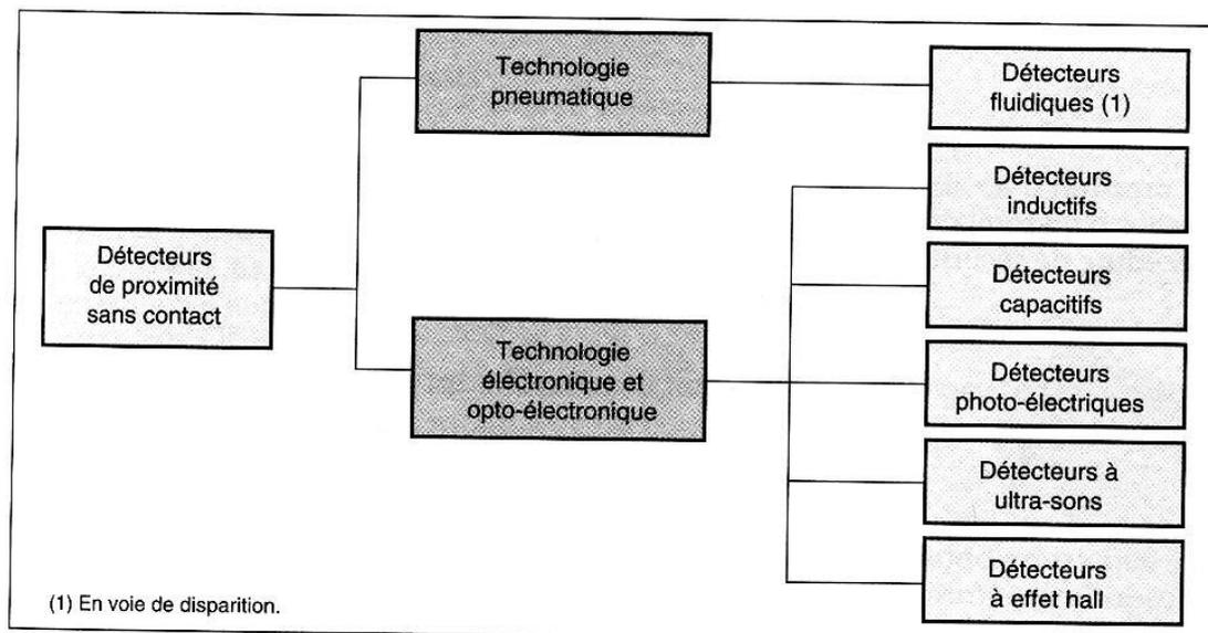
Figure 12 - Typologie des détecteurs de proximité sans contact
