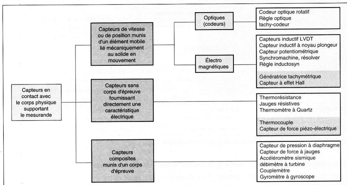
Figure 3.21. Typologie des capteurs en contact avec le corps physique supportant le mesurande (capteurs actifs en gris)
