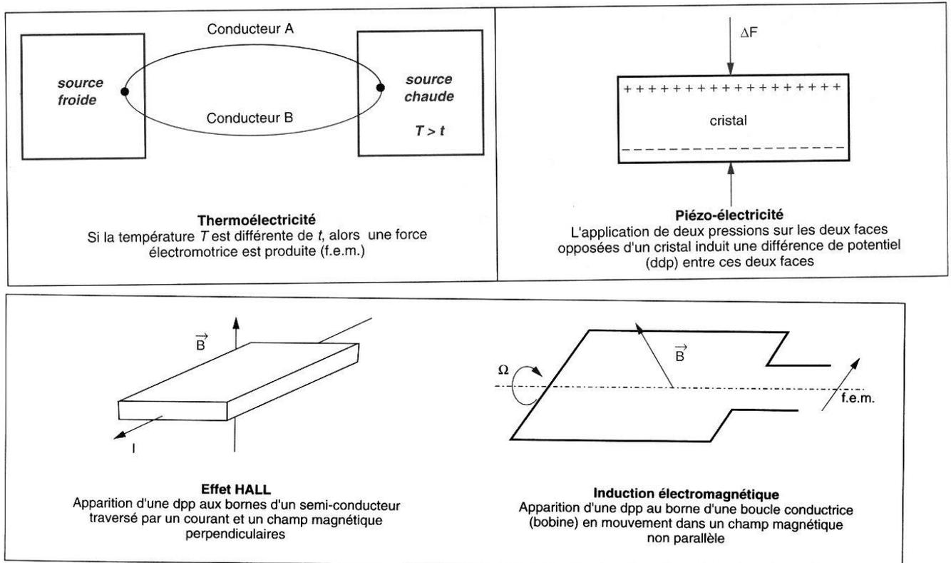
Figure 16 - Capteurs actifs: principes physiques utilisés
