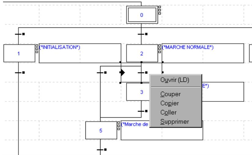
Les transitions peuvent être programmées en Ladder (LD), en structuré (ST), ou en instruction list (IL). Les symboles Ladder apparaissent de nouveau en bas de l'écran. Ils sont également accessibles par les touches fonctions (F1 à F12).
