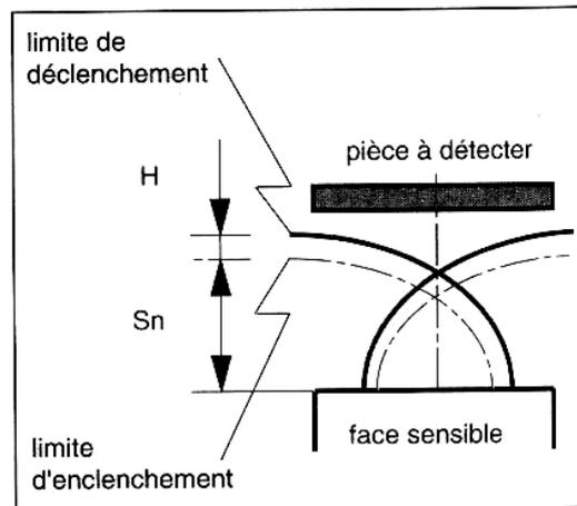
Figure 10 – Zone d'enclenchement d'un détecteur inductif
