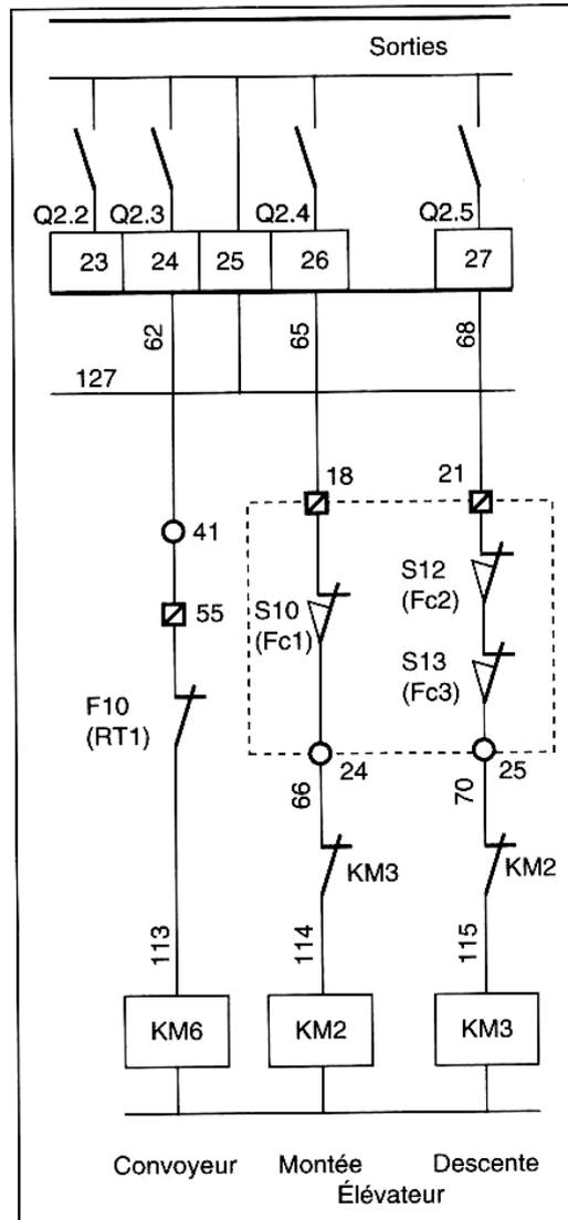
Figure 29 – Schéma de câblage des pré-actionneurs
