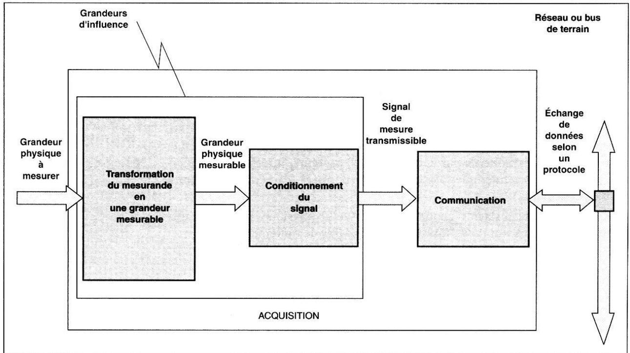
Figure 3 – Exemples de structure d'une chaîne d'acquisition de données
