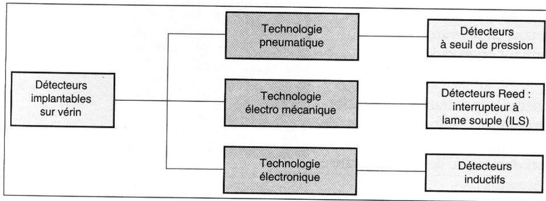
Figure 13 - Typologie des détecteurs implantables sur vérin
