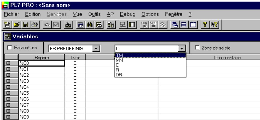
Il est possible de modifier la valeur de présélection en mode connecté, mais pour qu'il soit pris en compte il faut passer l'automate en "STOP", faire une initialisation "INIT", puis repasser l'automate en "RUN". Une fois la modification terminée valider et fermer la fenêtre.
