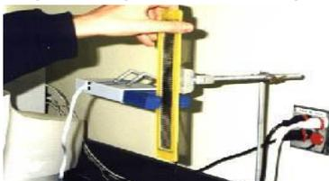
Acquisition des données avec l'interface portable munie d'un capteur photoélectrique.
