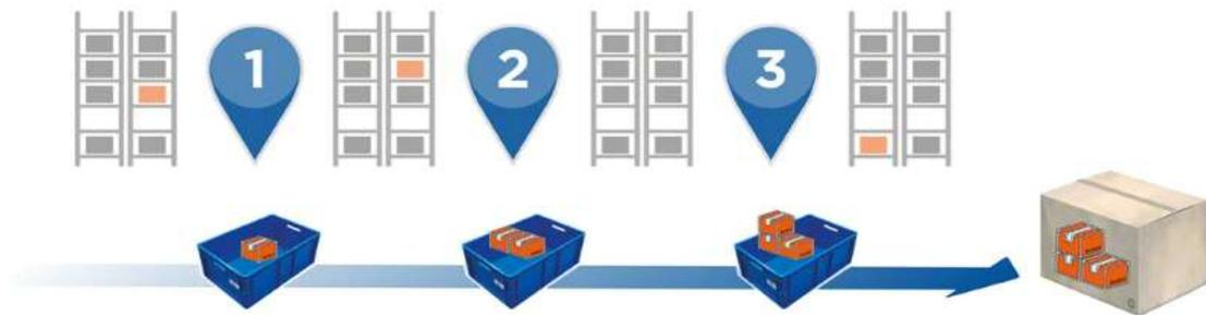
Dans le picking par zones séquentiel, le bac traverse les différentes zones de stockage
