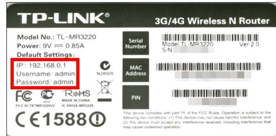
Un exemple Configuration par default d'un routeur 3G/4G avec le mot de passe et l'url d'accès
