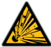
Matières explosives Risque d'explosion
