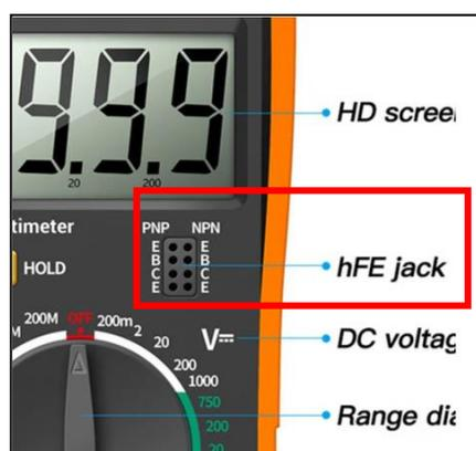
En effet, si le transistor est mal inséré ou si l'une de ses jonctions est défectueuse, le multimètre indique 0 ou 1 clignotant, si le transistor est en bon état, le multimètre affiche une valeur qui correspond à  $\beta$ .
