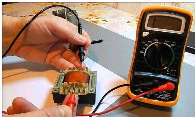
Pour tester rapidement le transformateur en circuit, on vérifie au multimètre hors tension avoir une résistance non infinie entre les bornes des bobines et sous tension avoir une première tension alternative aux bornes de la bobine primaire et une deuxième tension alternative aux bornes de la bobine secondaire respectant le rapport de transformation.
