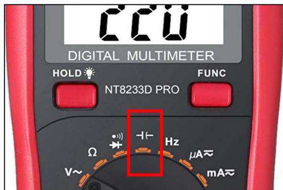
1. Pointer le bouton sur le réglage de la capacité.
