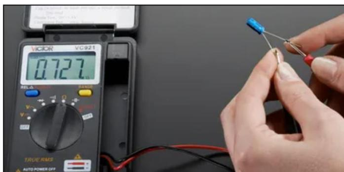
1. Régler le commutateur sur le mode ohmmètre (grand calibre) et effectuer les connexions correctement.
