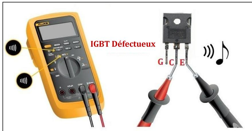
Si le buzzer du multimètre n'est pas activé (grande résistance), l'IGBT est en bonnes conditions.
