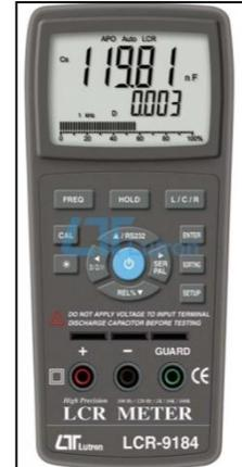
**Exemple d'illustration : mesure des éléments du schéma équivalent d'un condensateur.**
