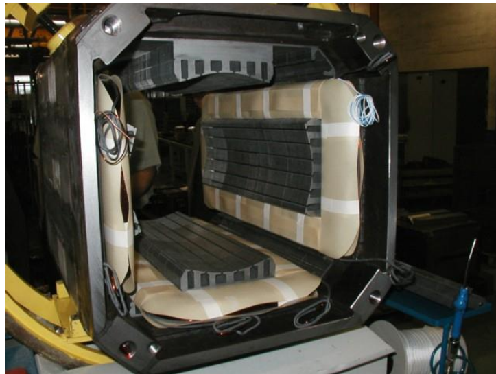
Mise en place des bobines sur le circuit magnétique statorique d'une machine à courant continu.
