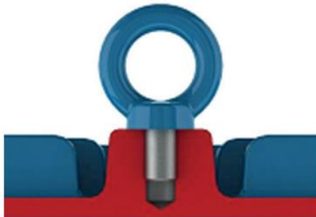
Serrage correct de l'anneau de levage
