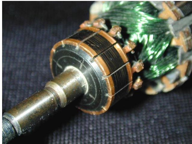
Collecteur d'une machine à courant continu de faible puissance.
