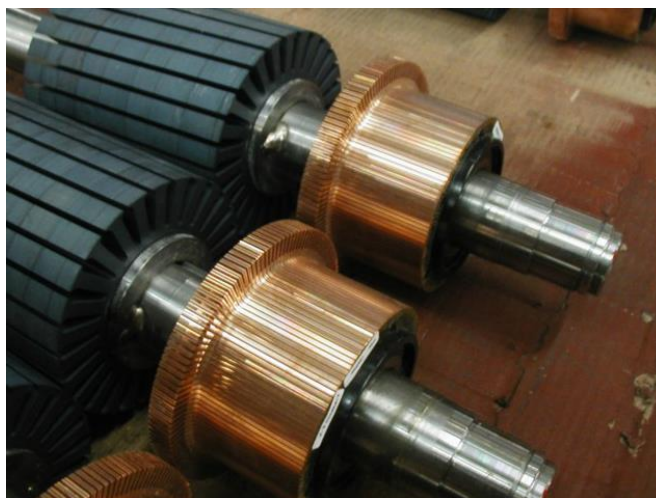
Collecteur d'une machine à courant continu de faible puissance.
