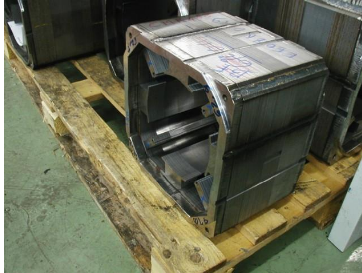
Culasse, circuit magnétique statorique d'une machine à courant continu.
