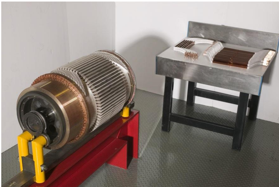
Mise en place des conducteurs d'induit dans les encoche et sou- dure de ceux-ci sur le collecteur.
