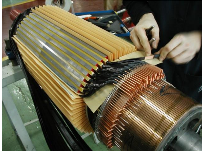
Mise en place des conducteurs d'induit dans les encoche et soudure de ceux-ci sur le collecteur
