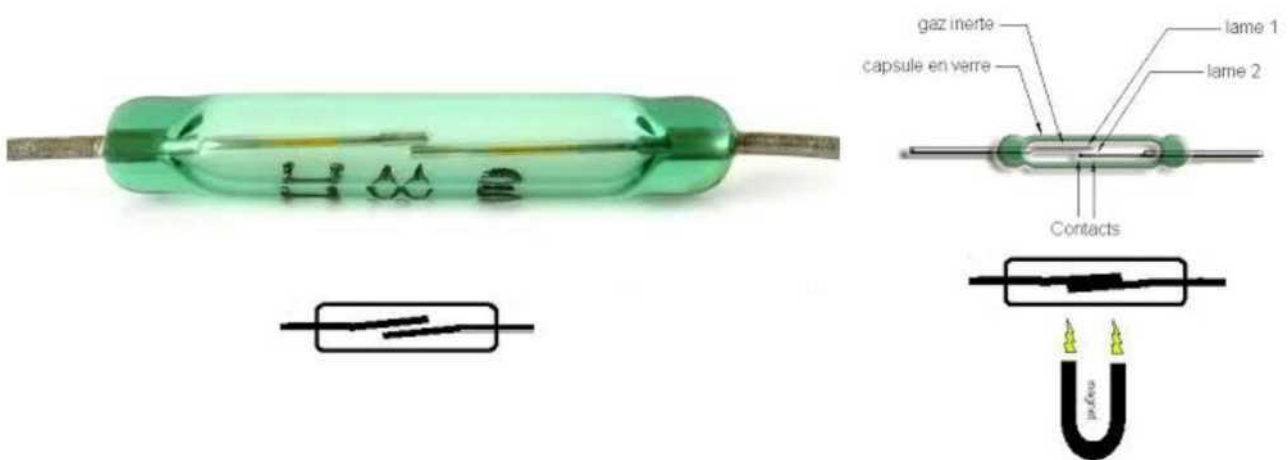
Figure: Interrupteur à lame souple
