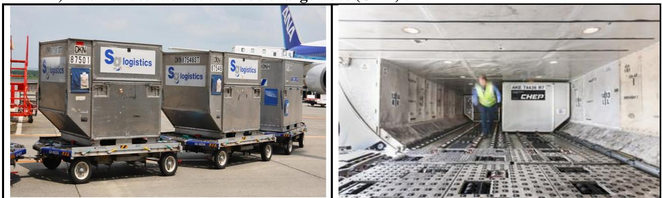
Les ULD ou unités de chargement sont des équipements utilisés pour le transport aérien de marchandise, ils peuvent être des conteneurs aériens (appelés aussi igloos) ou des palettes. Pour le fret aérien, les ULD doivent être conçus pour le fuselage de chaque type d'avion et permettent une utilisation optimale de l'espace disponible et facilitent le chargement et le déchargement.
