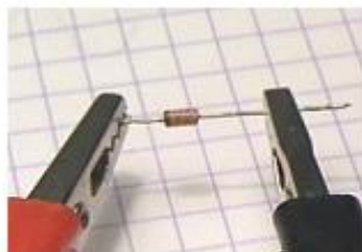
Fil rouge coté bague et fil noir à l'autre passe: le courant masse
