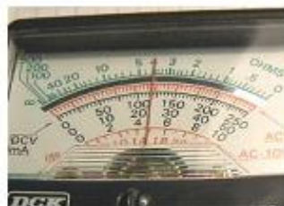
Le contrôleur est commuté en ohmmètre: ici on lit 40 ohms
