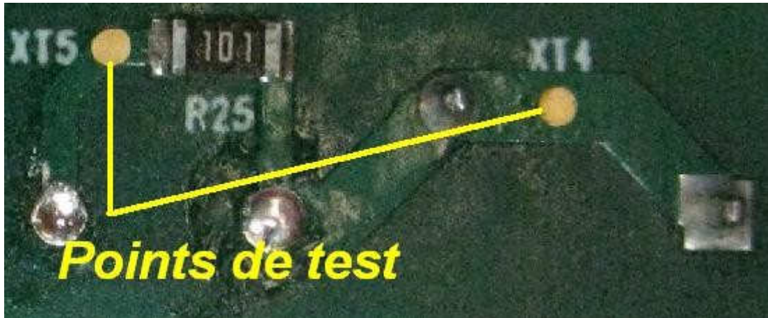
Figure 4.2: Point de test : surface sans vernis
