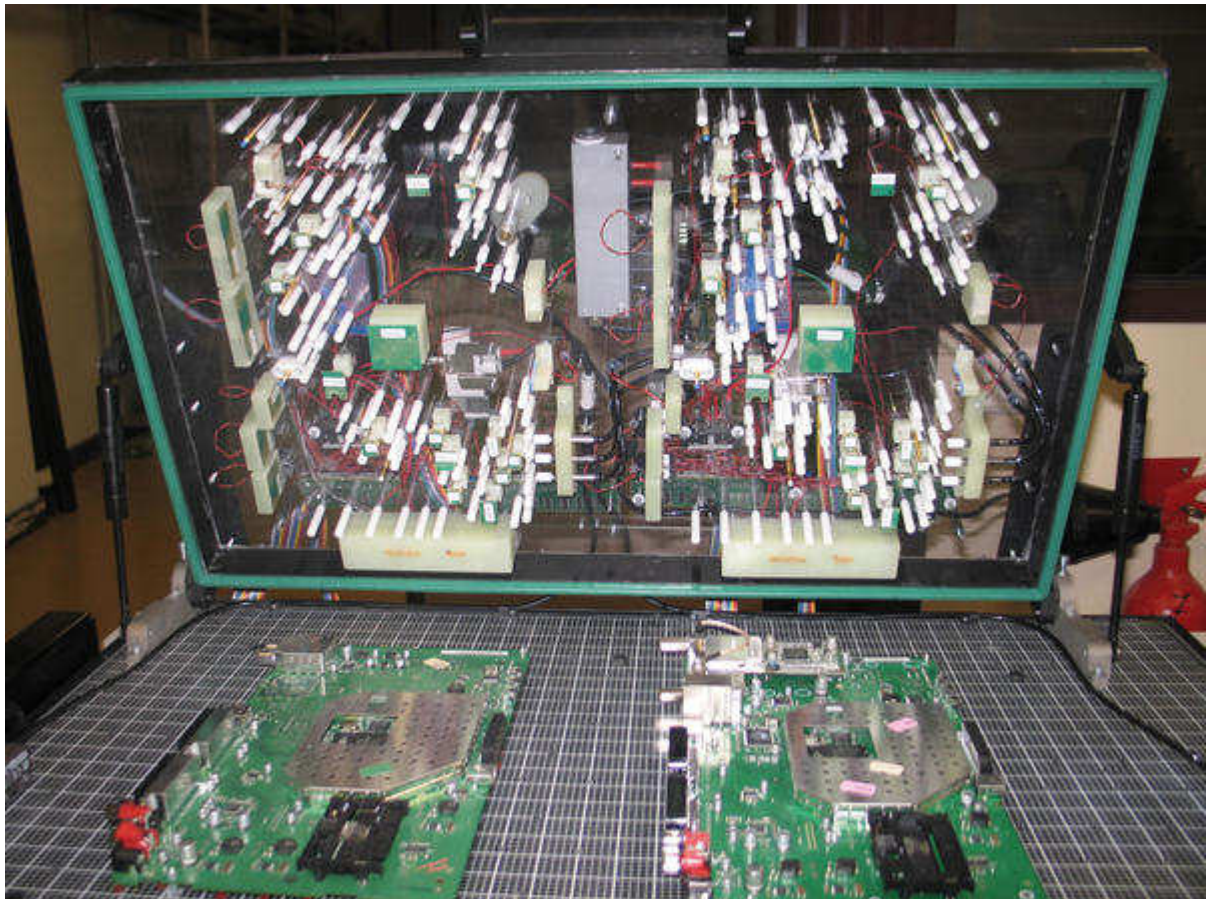
Figure 6.3 : Interface de test pour décodeur TNT (Testeur Agilent HP3070)
