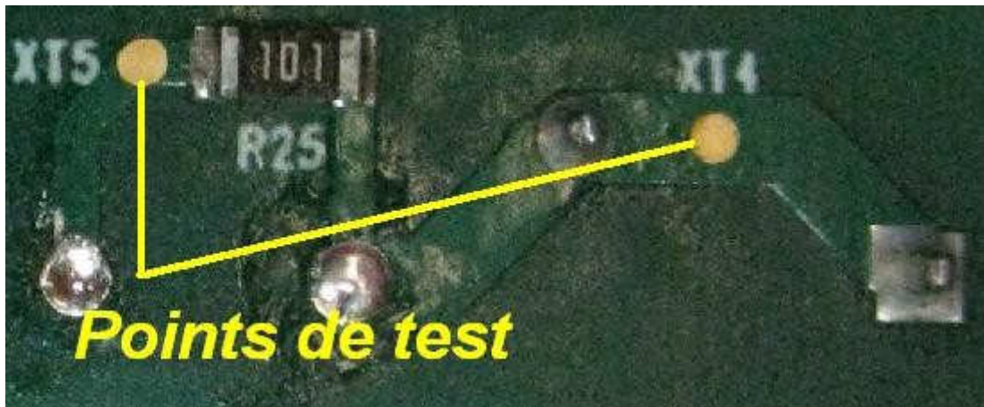
Figure 4.2: Point de test : surface sans vernis
