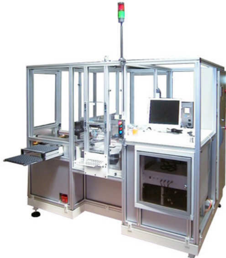
Figure 4.3: lignes automatisées avec postes de tests, cellules vision et lits à clous
