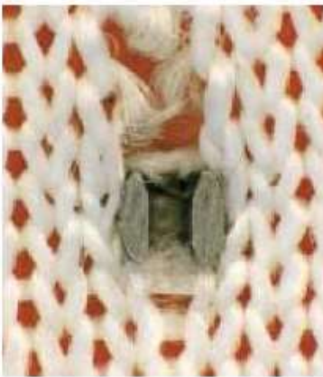
Matière en maille avec fil cassé après le choix d'une mauvaise grosseur et d'une fausse pointe d'aiguille.
