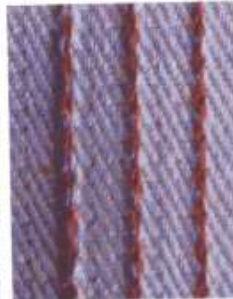
2. Tissus tissés endommagés À droite: couture avec fils, à gauche: couture sans fil: Nm 80, Nm 90, Nm 100 (de gauche à droite)
